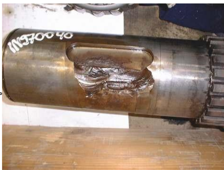
图 5：轴上的材料破裂 [2]
